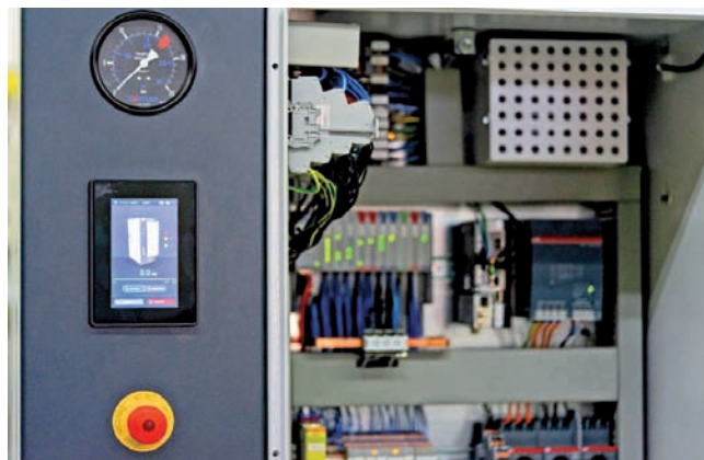
Grafické používateľské rozhranie (GUI) na TX705 HMI bolo dôkladne inovované v úzkej spolupráci so spoločnosťou Turck, aby zabezpečilo používateľskú prívetivosť špecifikovanú spoločnosťou Certuss.
